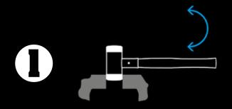
Bloccare saldamente l'inserto usato in una morsa e staccare l'inserto con un movimento laterale.
