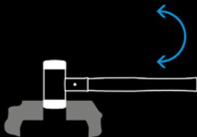
Sujetar firmemente la boca a cambiar en un tornillo de banco y aflojarla con un movimiento lateral de rotación.
