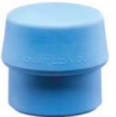
Der SIMPLEX-Schlageinsatz TPE-soft ist ein Thermoplast Elastomer und mit einer Härte von ca. 65 Shore A der weichste Einsatz in der SIMPLEX-Serie. Dieser blaue Schlageinsatz ist stark dämpfend und somit für sensible Arbeiten bestens geeignet. Er hinterlässt im Vergleich zum herkömmlichen Gummihammer keinen unerwünschten schwarzen Abrieb.
