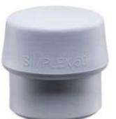
Der SIMPLEX-Schlageinsatz TPE-mid ist ein Thermoplast Elastomer und mit einer Härte von ca. 90 Shore A ein mittelharter Schlageinsatz (vergleichbar mit der Härte des Gummikompositionseinsatzes Serie 3202). Dieser graue Einsatz hinterlässt im Vergleich zum herkömmlichen Gummihammer keinen unerwünschten schwarzen Abrieb.
