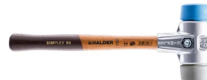
Beim Fliesen legen kommt es auf den sensiblen Umgang mit dem Schonhammer an! Der SIMPLEX-Schonhammer in Ø 40 mm mit Aluminiumgehäuse ermöglicht aufgrund seines geringen Gewichts von 345 g das nötige Feingefühl. Am vorsichtigsten lässt es sich mit dem blauen, weichen TPE-soft-Einsatz arbeiten. Wer etwas mehr Schlagkraft benötigt, schlägt mit dem grauen, mittelharten TPE-mid-Einsatz zu. Beide Einsätze sind abriebfrei und hinterlassen keine unerwünschten Spuren auf den Fliesen!
