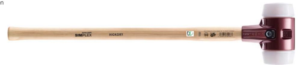
Holzpfähle splintern, wenn sie mit Stahlhämmern oder Schonhämmern mit einem zu kleinen Kopfdurchmesser eingeschlagen werden. Deswegen bietet HALDER den SIMPLEX-Vorschlaghammer mit Superplastik-Einsätzen und extra großem Ø 125 mm an. Die rückschlagfreien Schlegel bieten eine erhöhte Schlagkraft und ihre komplett flachen Nylon-Einsätze sorgen zusätzlich dafür, dass die Pfähle nicht splintern.
