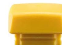
Der Schlageinsatz für den SECURAL-Schonhammer ist mit einer Shorehärte von ca. 60 Shore D mittelhart. Aufgrund seiner rechteckigen Form macht er den SECURAL zum wahren Spezialisten für Ecken und Kanten. Diese gelben Einsätze aus Polyurethan sind widerstandsfähig und wirken dämpfend.
