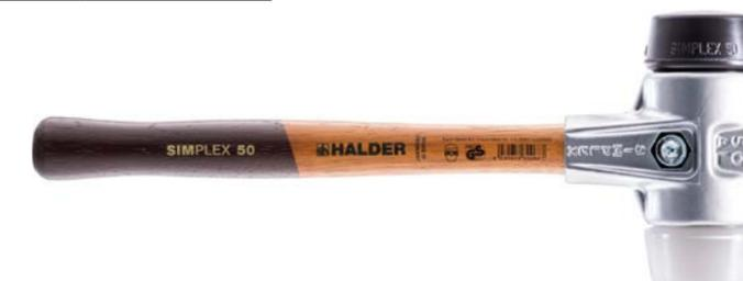
Für die Baumkontrolle bietet HALDER einen leichten Schonhammer mit Aluminiumgehäuse und ∅ 40 mm von nur 375 g, der einfach mitzuführen ist. Die unterschiedlich harten Schlageinsätze aus Gummi und Superplastik sorgen für die nötige Flexibilität.
